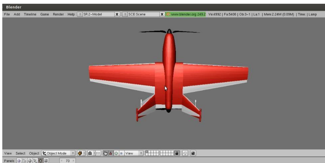
Рис. 2.4. Графічна модель БПЛА в графічному редакторі Blender
